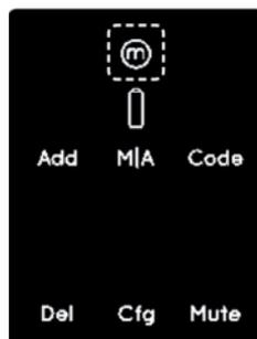
⇒ Je nach Sperrmodus leuchtet die Anzeige [M-Manuell] bzw. [A-Automatik] auf.
