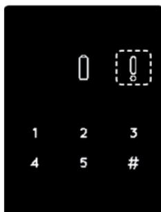
⇒ Bei fehlerhafter Konfiguration leuchtet die Anzeige [!] und zwei lange Signaltöne erklingen.
