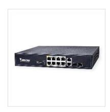
VIVOTEK AW-FGT-100D-120 Unmanaged 8xFE PoE + 2xGE Kombi Switch, speziell für IP-Überwachungsanwendungen, Blitzschutz für AC Stromversorgung & PoE Überspannungsschutz, ST Modus erreicht PoE Kamera bis zu 100M@100Mbps über jeden Port, EX Modus erreicht 802.3af/at Kamera bis zu 250m@10Mbps über EX PoE Ports
