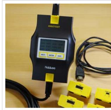
**Der INNOTEST Modularer Kabeltester ist die neueste Innovation der Prüftechnik auf dem Markt. Es ist der erste Tester seiner Art im Moduldesign. Er arbeitet mit austauschbaren Modulen, sodass immer der benötigte Anschluss vorhanden ist. In dieser Version kommt er im Koffer zusammen mit 4 Modulen zum Test von HDMI-Kabeln**
