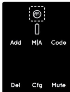
⇒ Je nach Sperrmodus leuchtet die Anzeige [M-Manuell] bzw. [A-Automatik] auf.
