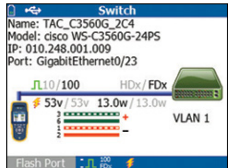
100 Mbps Link auf Kupferverbindungen mit PoE auf dem Port 23
