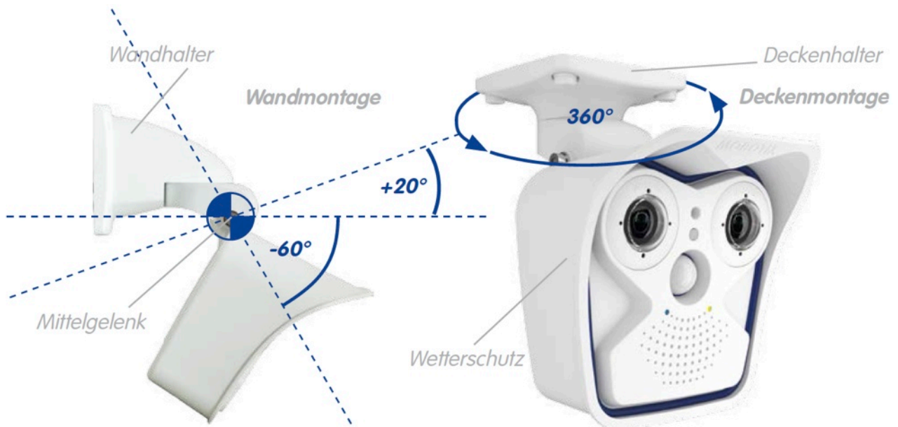
(M15 – Montageoptionen, Auszug aus der technischen Dokumentation)
