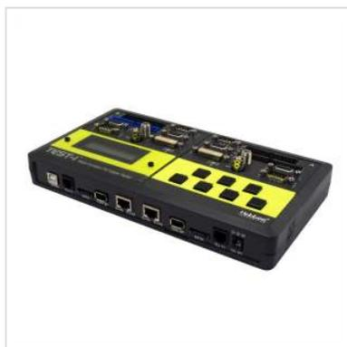
**Die dritte Generation des PC Kabeltesters-Hobbes TEST-i - All-in-One Universal-Kabeltester / Schnittstellen-Tester, ist ein speziell gestalteter Multifunktions-Kabeltester, der eine Vielzahl von PC-Kabeln und die meistverwendeten Flachbandkabel testet und analysiert.**
