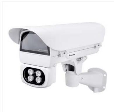
VIVOTEK AE-244 ist ein Außengehäuse mit 30W (50-57VDC) POE Eingang. Das IP68/IK10 Außengehäuse bietet Schutz vor Regen, Staub und Vandalismus. Zudem, eine IR-Beleuchtung (VAIR LED) bis 50m ist in der Grundausstattung enthalten. Das Außengehäuse besitzt zusätzlich eine Antibeschlag-Belüftung.
