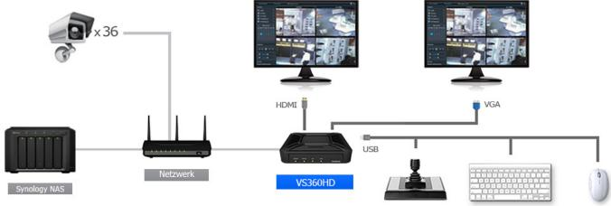
Videoüberwachung leicht gemacht mit der VS360HD
